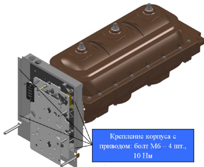
Рисунок 22а. Крепление лицевой стороны аппарата
