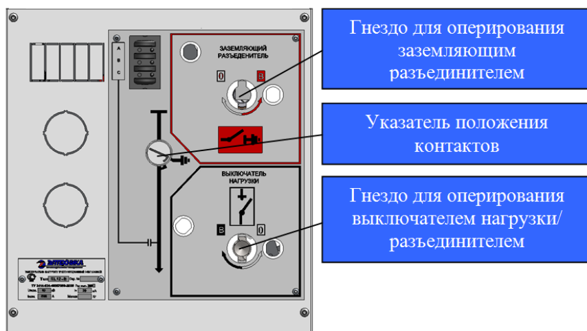
Рисунок 9а. Общий вид привода типа «Н» (с ручным оперированием).
