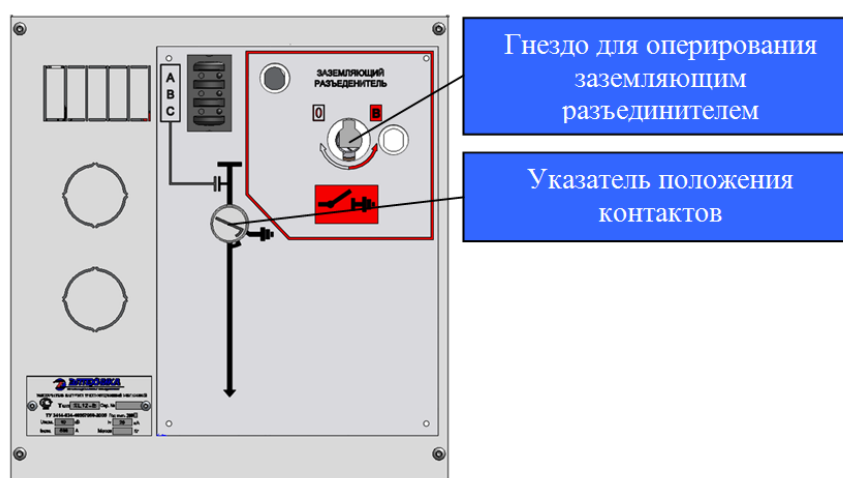
Рисунок 9б. Общий вид привода «Н» для аппаратов SL12-Е.
