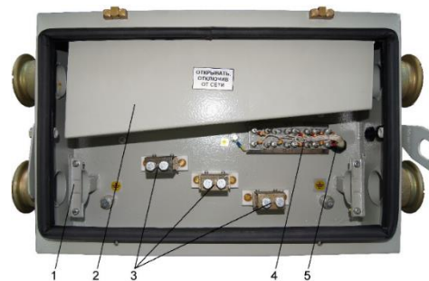
Рис. 2 Камера пускозащитной аппаратуры. 1 – крышка; 2 – выключатель автоматический; 3 – кабельный ввод контрольного кабеля; 4 – кабельный ввод силового кабеля; 5 – ручка; 6 – рукоятка выключателя автоматического; 7 – механизм блокировки дверцы с выключателем автоматическим; 8 – контакторы КМ1 и КМ2; 9 – зажим заземляющий; 10 – салазки; 11 – блок управления БУКС-1РС; 12 – переключатель напряжения 660/380В; 13 – защитная крышка панели управления ПСУ-1Р.
