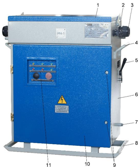
Рис. 1 Общий вид пускателя. 1 – крышка камеры вводов; 2 – кабельный ввод контрольного кабеля; 3 – кабельный ввод силового кабеля; 4 – ручка; 5 – рукоятка автоматического выключателя; 6 – корпус; 7 – зажим заземляющий; 8 – салазки; 9 – запорное устройство дверцы; 10 – дверца; 11 – панель ПСУ-1Р.
