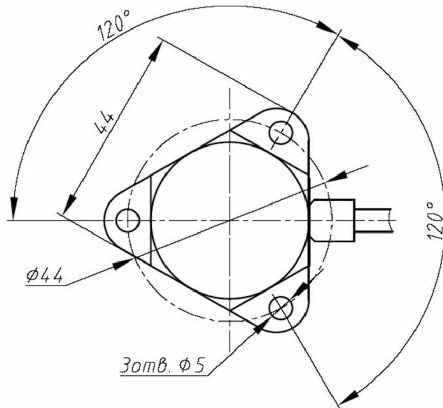
Приложение 2. Установка датчиков ДВСТ на объекте.
