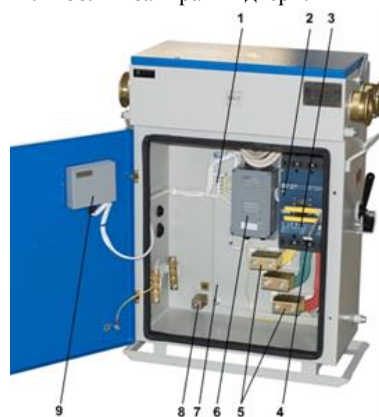
Рис. 3 Общий вид ВР-250Р справа. 6 – салазки; 7 – панель ПСУ-2Ф; 8 – кабельные вводы контрольных кабелей; 9 – кабельные вводы отходящих силовых кабелей (2 шт.); 10 – болты запираения двери.
