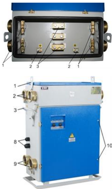
Рис. 2 Общий вид ВР-250Р слева. 1 – проушины; 2 – вводы сеть и транзит (4 шт.); 3 – ручка; 4 – рукоятка автоматического выключателя; 5 – зажим заземляющий;
