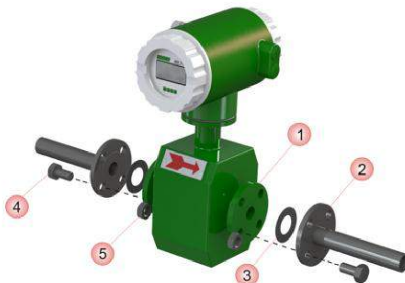
Рисунок 2.3 – Установка расходомера ЭМИС-МАГ 270 на трубопровод
