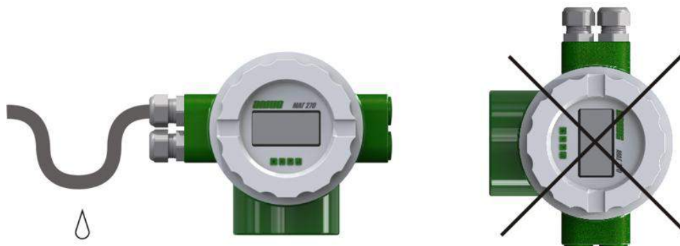
Рисунок 2.8 - Рекомендации по расположению кабелей и кабельных вводов
