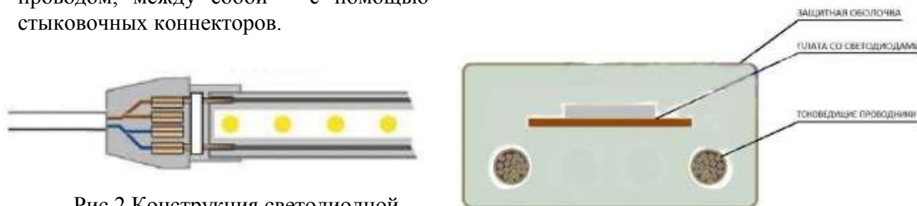
Рис.2 Конструкция светодиодной ленты ЛСР-12,0-220 и подключение с помощью коннекторов-преобразователей.
