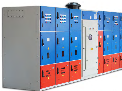
Комплект электрооборудования плавного пуска высоковольтных электродвигателей типа KPPVZ-6 - для поочередного плавного пуска и останова нескольких электродвигателей насосных агрегатов от одного устройства плавного пуска УППВ-6-РН .
