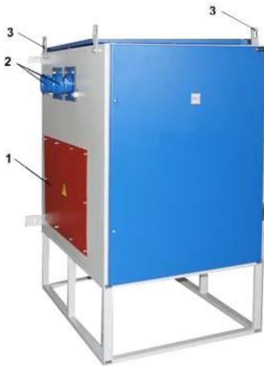
Рис.3 Внешний вид КРУ-РН-РТ с левого бока. 1 – боковая дверь кабельного отсека для удобства подключения отходящего кабеля (блокируется внутри отсека через проем передней двери); 2 – кабельные вводы транзитного (сетового) кабеля – 2 шт.; 3 – проушины для подъема.
