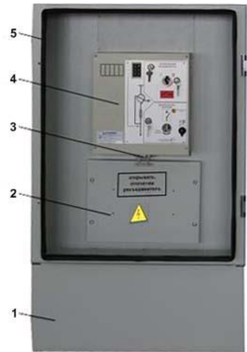
Рис.4 Вид спереди с открытой дверью. 1 – лист ограждения цоколя; 2 – дверь кабельного отсека отходящего кабеля; 3 – механизм блокировки двери с заземлителем; 4 – панель управления ВНТ; 5 – уплотнитель резиновый.
