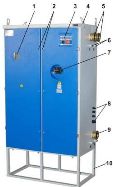
Рис. 6 Общий вид пускателя ПРЧ-250М. 1 – смотровое окно панели управления LCP; 2 – запорные устройства отсека ПЧ и QF; 3 – панель ПСУ-1ПЧ; 4 – проушина; 5 – ввод сетевого и транзитного кабеля; 6 – зажим заземления; 7 – рукоятка привода автоматического выключателя; 8 – выходы контрольного кабеля; 9 – ввод отходящего кабеля; 10 – подставка.
