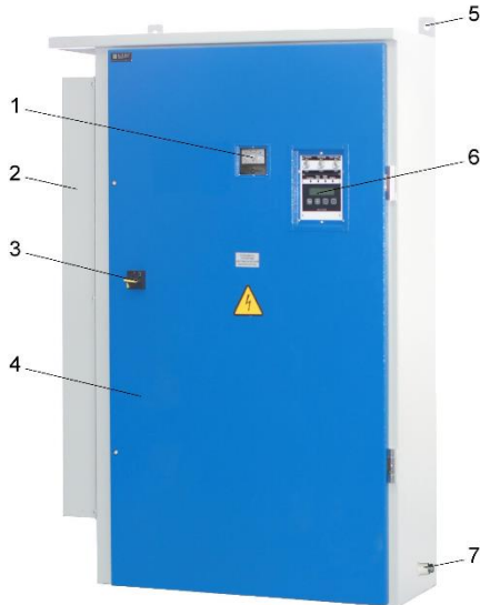
Рис. 1 Внешний вид ЗУША-РП. 1 – Измеритель-регулятор ТРМ; 2 – Кожух радиатора охлаждения; 3 – Рукоятка автоматического выключателя с блокировочным механизмом; 4 – Дверца отсека автоматики; 5 – Проушина; 6 – Вольтметр; 7 – Панель ПСУ; 8 – Зажим заземляющий.
