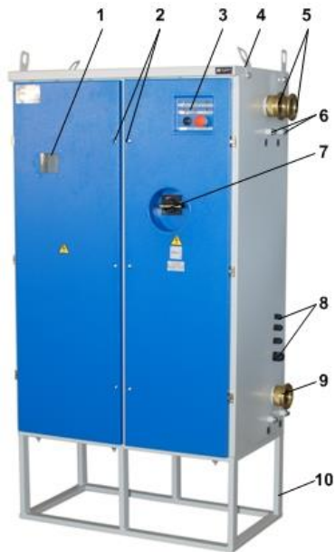
Рис. 6 Общий вид пускателя ПРЧ-250М. 1 – смотровое окно панели управления LCP; 2 – запорные устройства отсека ПЧ и QF; 3 – панель ПСУ-1ПЧ; 4 – проушина; 5 – ввод сетевого и транзитного кабеля; 6 – зажим заземления; 7 – рукоятка привода автоматического выключателя; 8 – выводы контрольного кабеля; 9 – ввод отходящего кабеля; 10 – подставка.
