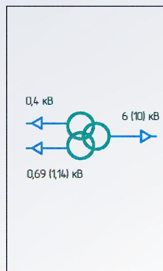
Пример состава модуля: двухобмоточный трансформатор общей мощностью до 630кВА и напряжением вторичных обмоток 0,4 и 0,69кВ. Мощность по каждому напряжению определяется ЗАКАЗЧИКОМ.
