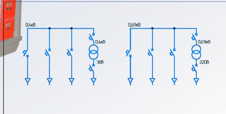
Предназначен для распределения электроэнергии напряжением 0,4кВ, контроля за состоянием изоляции сети и подключаемого оборудования. Отсеки могут состоять из одного вводного автоматического выключателя с РУ (АЗУР) и тремя отходящими. Возможна комплектация АОШ с выходным напряжением на 36, 127 или 220В. Компоновка модуля силового определяется «Заказчиком» по опросному листу.
