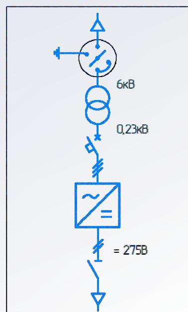
Представляет собой силовой преобразовательный трансформатор мощностью 160кВА совмещенный с АТПУ-500/275В в одном модуле. Предназначен для энергоснабжения контактной сети горной выработки.
