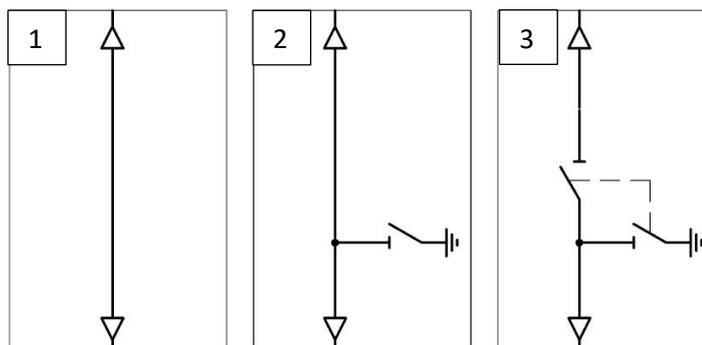
1. соединительная (без заземлителя и разъединителя);
