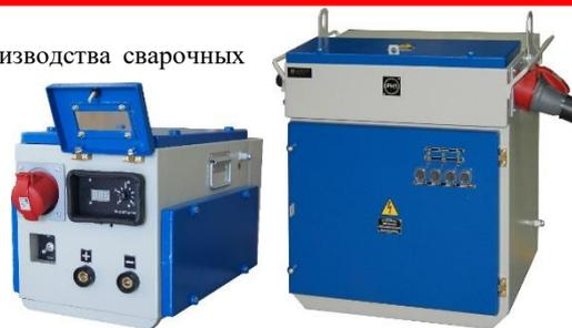
Модуль питания типа РИП-5,0 предназначен для преобразования сетевого напряжения 1,14/0,69кВ в 0,4кВ, необходимого для питания сварочного модуля РСА-250. Обеспечивает защиту от токов короткого замыкания и перегрузки, а также имеет встроенное реле утечки РУП-380/220.
