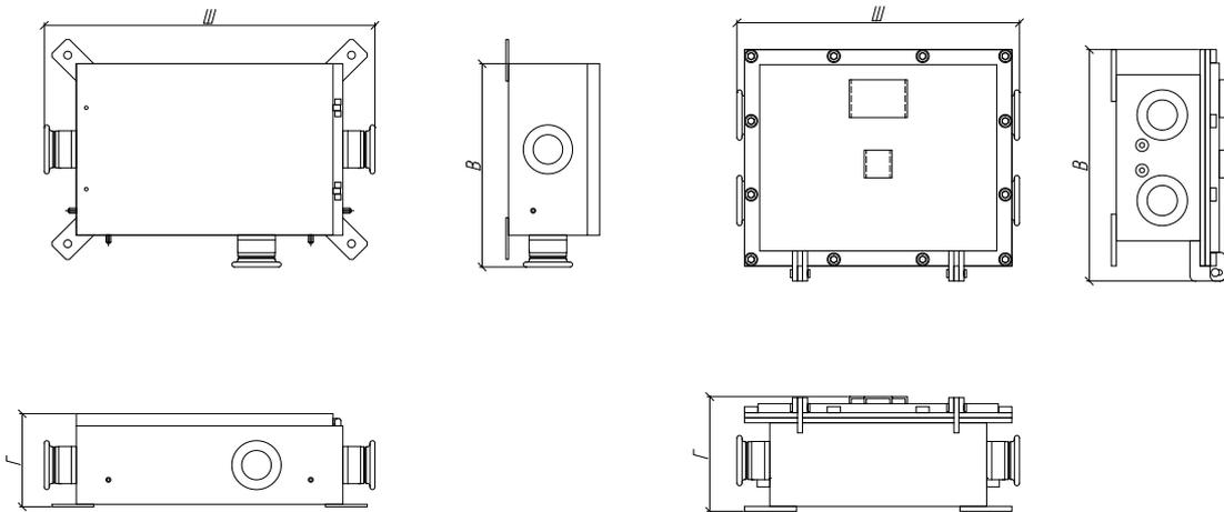
Рис. 3 Вид КСР – 250 ... 630 в стандартном исполнении (слева) и в корпусе повышенной прочности (справа).
