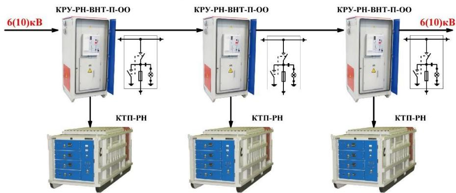
**ВАРИАНТ ПОДКЛЮЧЕНИЯ ТРАНСФОРМАТОРНЫХ ПОДСТАНЦИЙ
