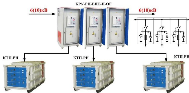
**ВАРИАНТ ПОДКЛЮЧЕНИЯ ТРАНСФОРМАТОРНЫХ ПОДСТАНЦИЙ
