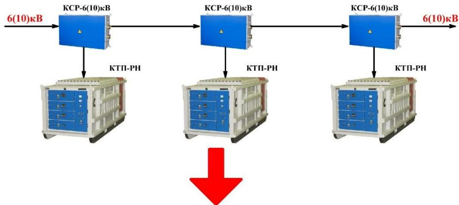
**ВАРИАНТ ПОДКЛЮЧЕНИЯ ТРАНСФОРМАТОРНЫХ ПОДСТАНЦИЙ
