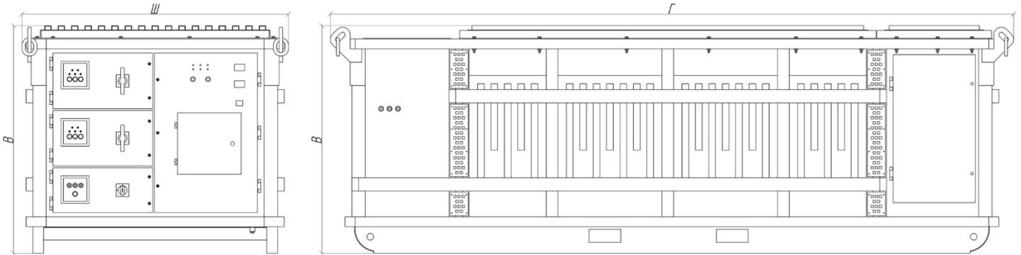
Комплектная трансформаторная подстанция многофидерная КТП-РН-М-1600кВА
