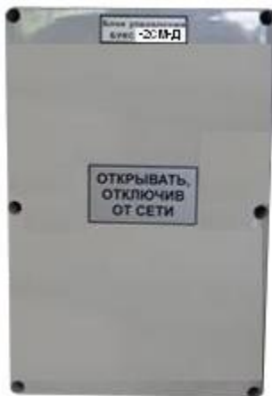
Рис. 12 Блок управления БУКС-2СМ-Д2
