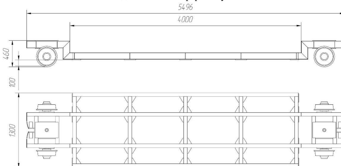
Рис.2 Чертёж общего вида тележки-платформы ТП-750 для колеи 750мм.
