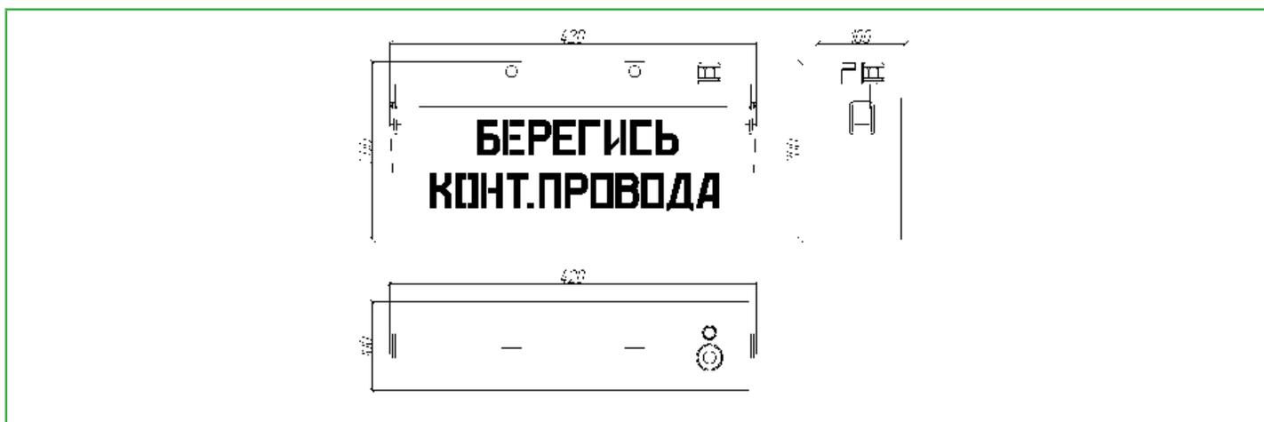
**Рис. 15** Конструкция табло сигнального ТС-БП
