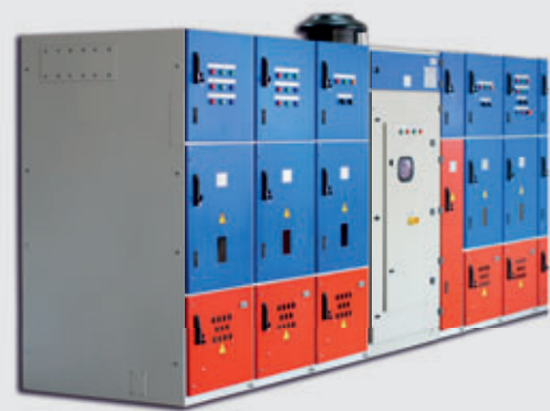
Комплект электрооборудования плавного пуска высоковольтных электродвигателей КППВЭ-6 предназначен для поочередного плавного пуска и останова нескольких электродвигателей насосных агрегатов от одного устройства плавного пуска - УППВ-6-РН .
