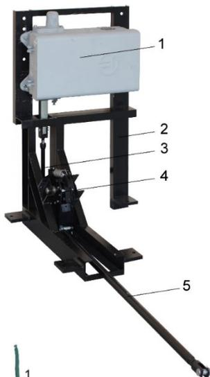
**Механизм вертикального электропривода
