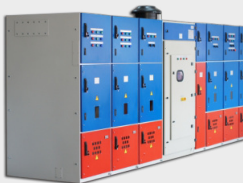
Комплект электрооборудования плавного пуска высоковольтных электродвигателей KPPB3-6 предназначен для поочередного плавного пуска и останова нескольких электродвигателей насосных агрегатов от одного устройства плавного пуска - УППВ-6-PH .
