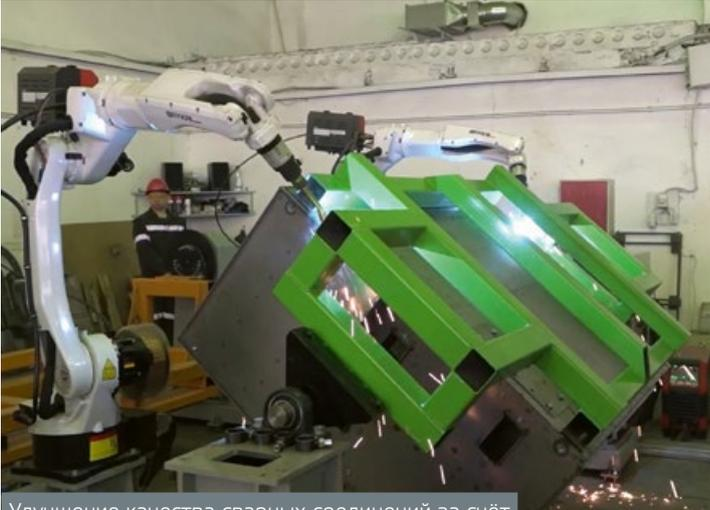
Улучшение качества сварных соединений за счёт роботизированного производства
